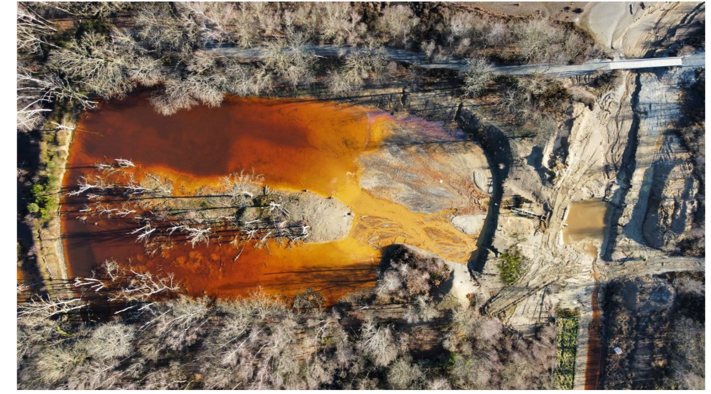
Lagune recueillant les eaux du DMA sur le site d'Abbaretz
